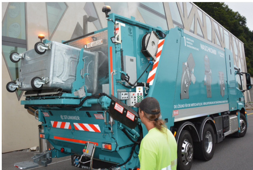
Testlauf: Ein Knopfdruck des Beladers Bruno Balmer hat genügt, die Heisswasser-Waschanlage in Betrieb zu setzen. Bild: Guido Lauper
